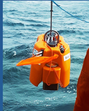
WBOBS compact Sensible aux télé-séismes, bruit ambiant, événements LF, relativement faciles à transporter et déployer;
