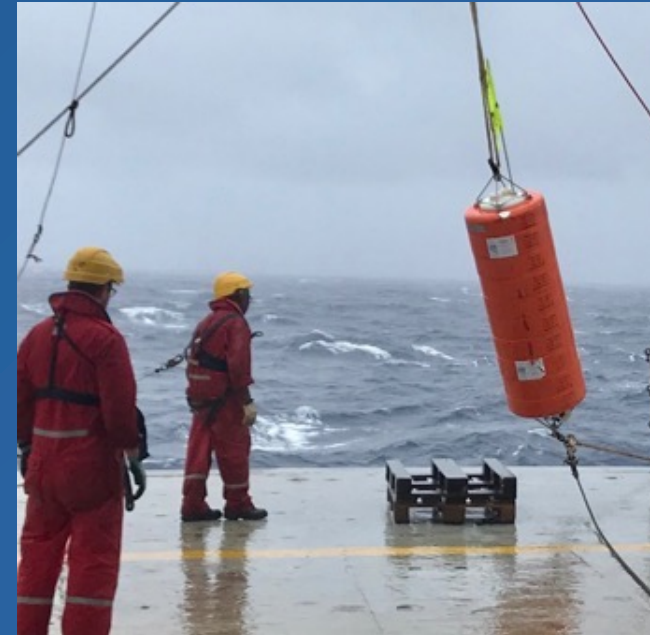
Hydrophone canal SOFAR Couvre très large zone avec peu d'instruments, haute sensibilité
