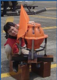
OBS sismique active Facile à préparer/transporter/déployer en grand nombre.
